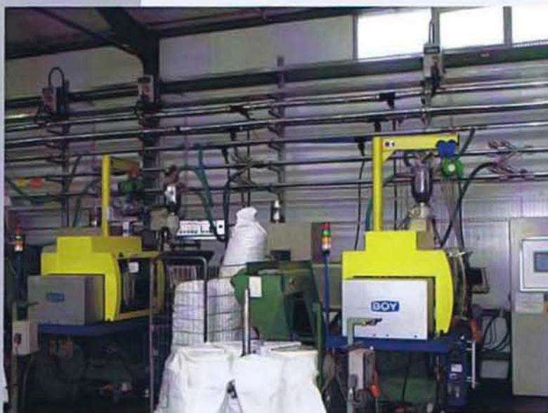
Die meisten Spritzgussteile in Cenas Produktion haben ein Gewinde. Um Zykluszeit zu sparen, startet der Ausschraubvorgang, noch während die Maschine auffährt
